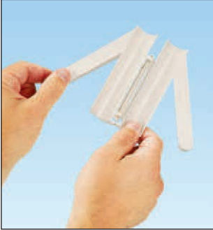
팬랩 작업 공구에 케이블 번들을 삽입한다.
